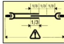
Die Schiebepprofile müssen während des Transportes und im Betrieb soweit wie möglich überlappen, jedoch nicht weniger als 1/3 der Profilrohrlänge.
