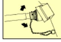
Halteketten so einhängen, dass ein ausreichender Schwenkbereich der Gelenkwelle in allen Betriebsstellungen gewährleistet ist. Kette nicht zum Aufhängen der Gelenkwelle benutzen.
