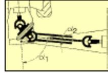
Bei Weitwinkelgelenken, abhängig von der Version 70° oder 80° ist der Betrieb im Max. - Winkel nur kurzzeitig zulässig und darf auch in der Ruhestellung nicht überschritten werden. Im Dauerbetrieb wird eine Gelenkabwinkelung von max. 25° zugelassen.
