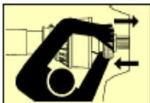
Vor jeden Einsatz überprüfen, ob Gelenkwelle und Schutztopf ordnungsgemäss befestigt sind. Schraubenköpfe und Unterlegscheiben müssen in der Befestigungsfläche versenkt sein.
